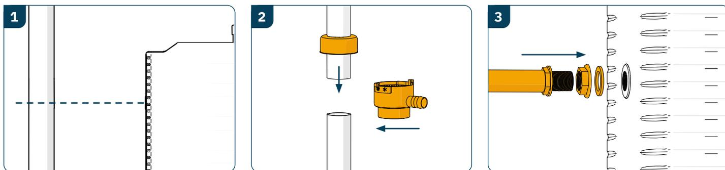
Couper le tuyau de descente au niveau de l'emplacement de récupération d'eau
