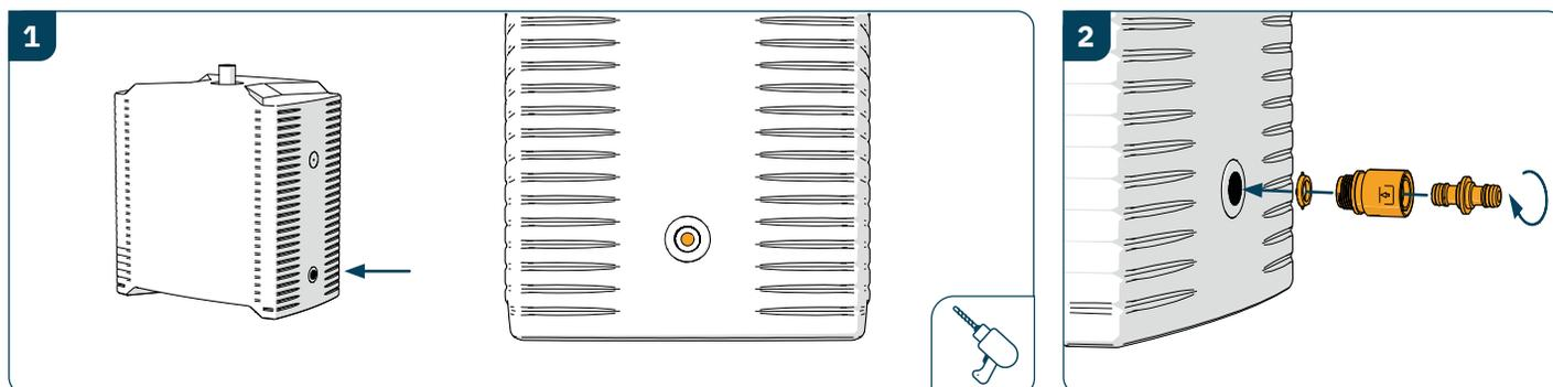
Percer un trou de  $\varnothing 14$  mm à l'endroit indiqué (sur les 2 récupérateurs).
