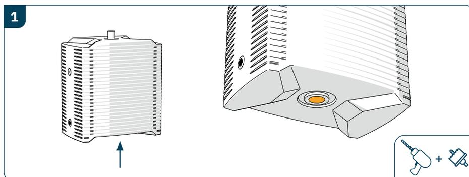
Percer le dessous du récupérateur avec une scie cloche Ø 54 mm
