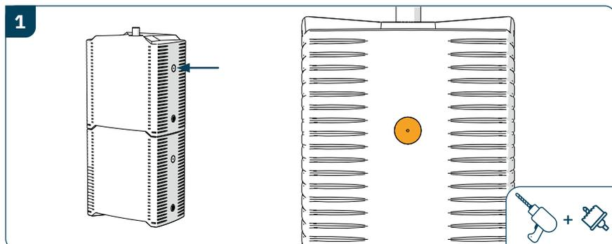
À l'aide de la scie cloche Ø 45 mm (fournie), percer l'emplacement indiqué. Assurez-vous de percer le récupérateur le plus haut.
