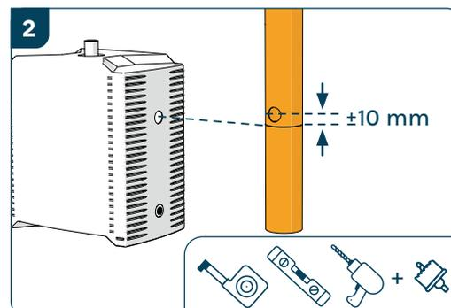
Percer la descente avec la scie cloche à 10 mm au-dessus du niveau du perçage réalisé sur le récupérateur.
