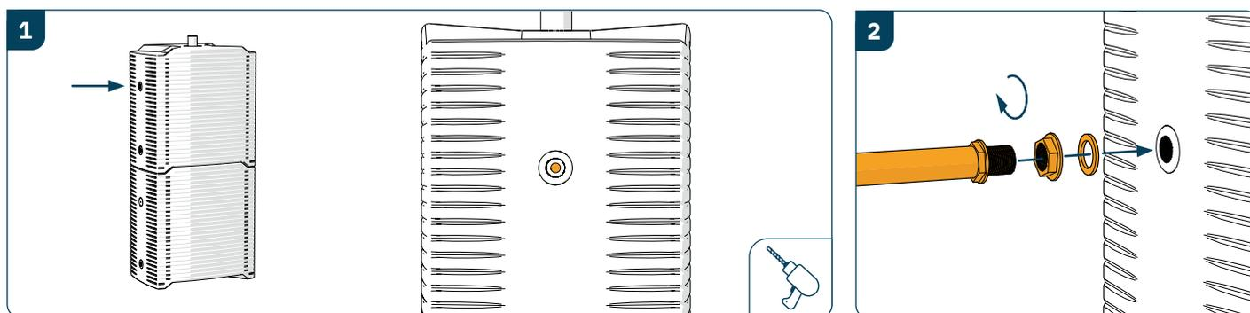
Percer un trou de  $\varnothing 14$  mm à l'endroit indiqué. Assurez-vous de percer le récupérateur le plus haut.
