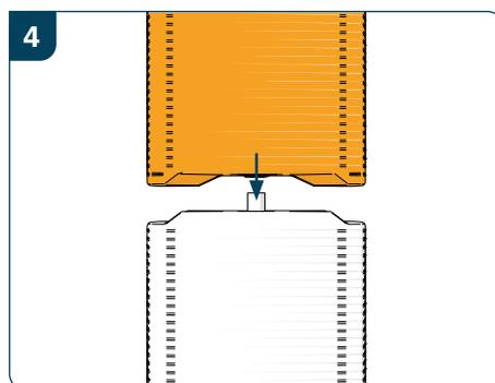
Graisser le joint et le tube pour faciliter l'emboîtement. Utiliser de la graisse silicone alimentaire (ou sanitaire).
