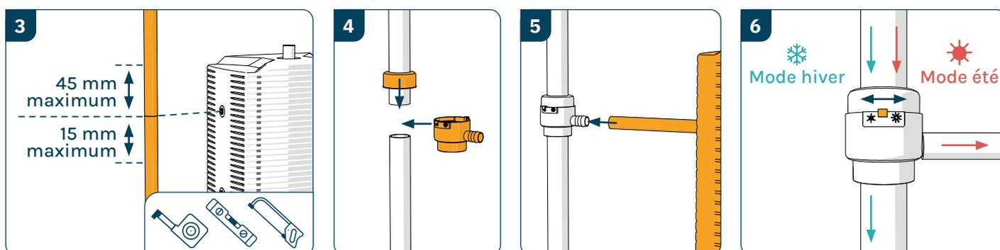
Repérer sur la descente le niveau du branchement du récupérateur. Puis couper la descente à 45 mm maximum au-dessus de ce niveau et à 15 mm maximum en dessous.
